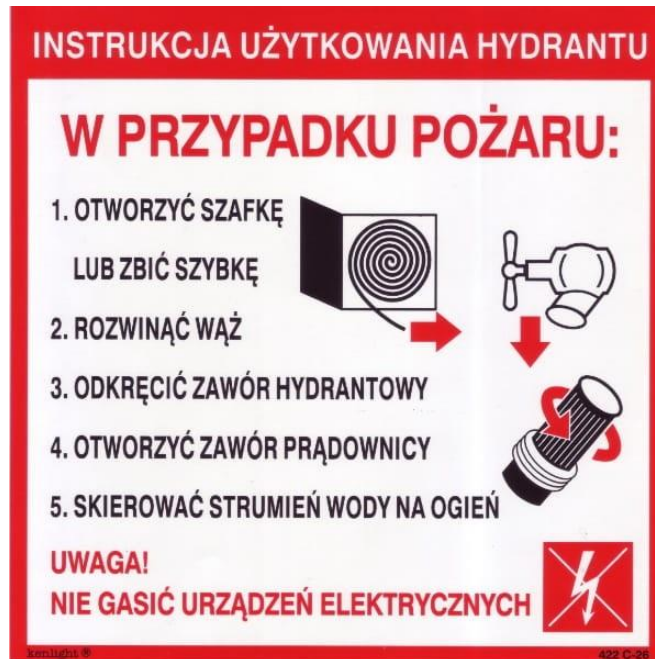
Rys. 15 Instrukcja użycia hydrantu
